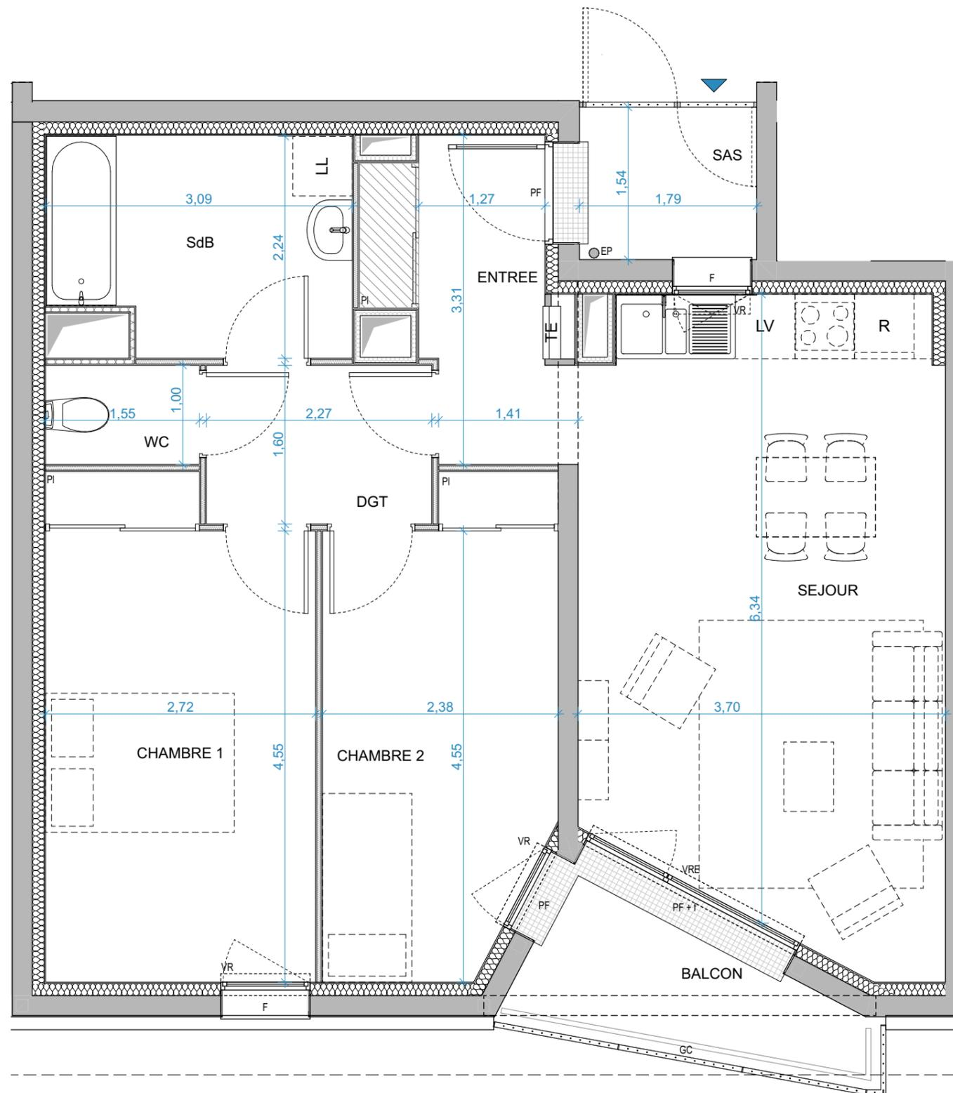
**LÉGENDE** TE : Tableau électrique VRE : Volets-roulants à commande électrique VR : Volets-roulants à commande manuelle EEP : Entrée d'eaux pluviales EP : Eaux pluviales PI : Placard BAL : Boîte de lettre 0 m 1m 3 m
