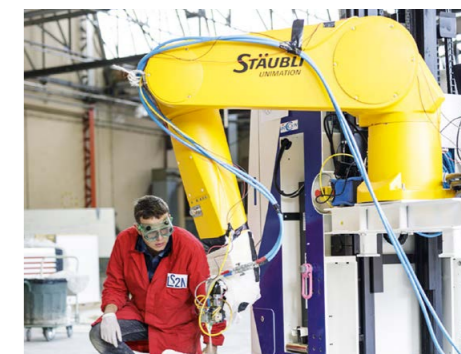
C'est ce robot imprimante qui va construire la maison YHNOVA en quelques jours.
